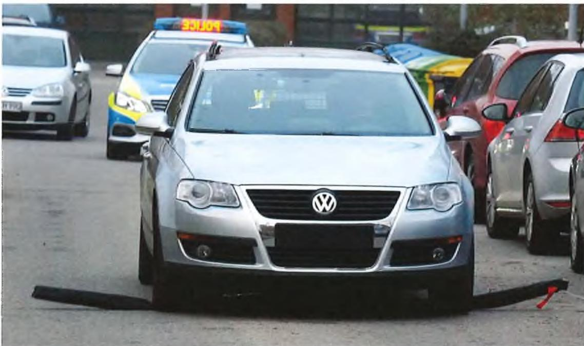
Sogenannte Stop Sticks gelten als Weiterentwicklung von Nagelsperren. Fährt ein Auto darüber, bohren sich spitze Ventile in den Reifen und lassen die Luft langsam ab.
